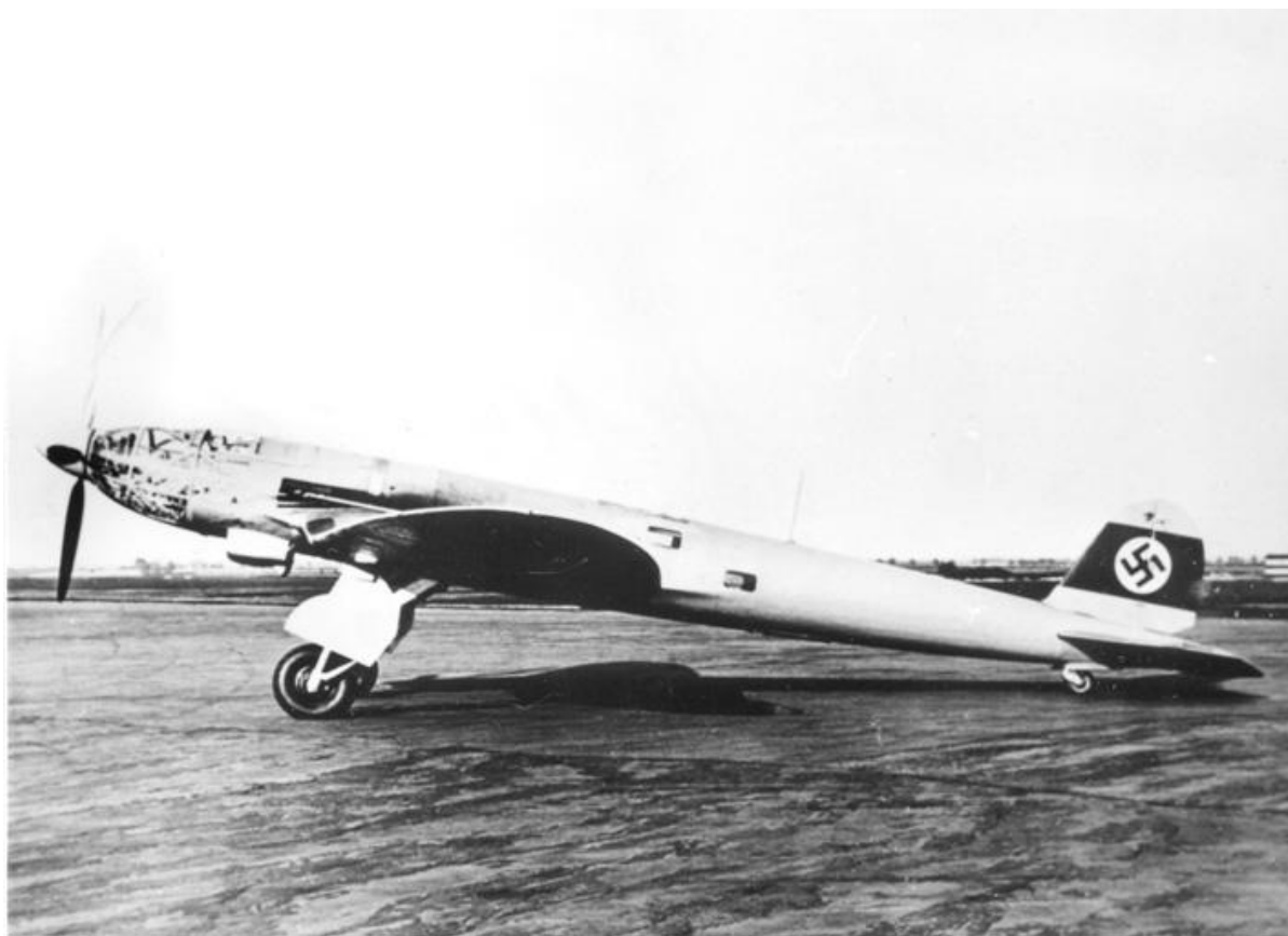
Seitenansicht der 1938 gebauten He 119 V2, die noch die elliptische Flächenform hatte.
