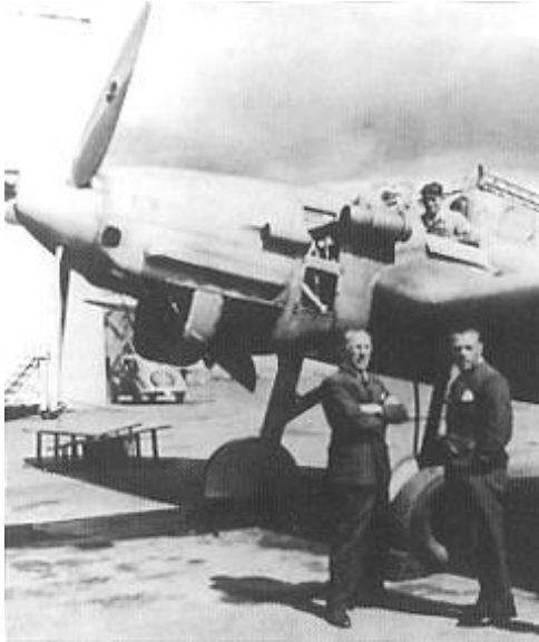
Diese He 118 A-0 diente Triebwerksversuchen bei Daimler-Benz.
