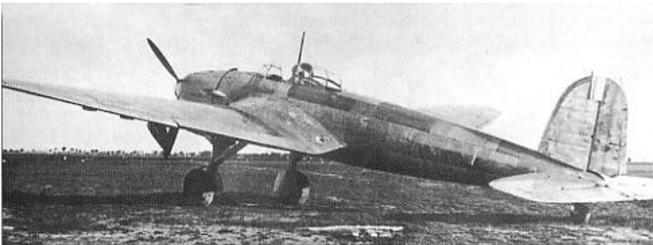
Die zweite He 118 für die japanische Marine hatte ein Metall-Leitwerk und klappbare Flügelenden. Auf dieser Ansicht ist die Flügeltrennstelle als Strich gerade erkennbar.
