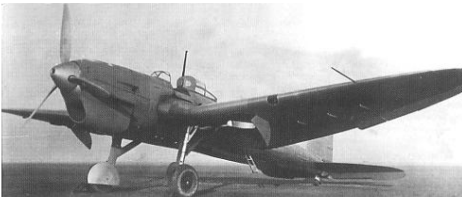
Auf dieser Ansicht der He 118 „Japan I“ (W.Nr. 1850) erkennt man unter der Tragfläche die Halterung der Sturzflugbremse.
