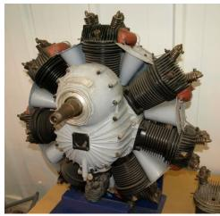
Der britische Siebenzylinder-Sternmotor Pobjoy "R" diente zum Antrieb der Fieseler F 3. Er leistete 75/85 PS und war seinerzeit der leichteste in seiner Klasse. Bedingt durch das Getriebe befand sich die Propellerachse oberhalb der Motorlängsachse.
