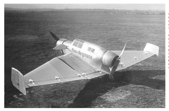
Das Musterflugzeug startbereit auf dem Flugplatz Kassel. Der Besatzungsraum trägt erstmalig eine vollkommen geschlossene Verglasung. Gut zu erkennen ist die "Knickstelle" auf Tragflächenmitteldem stück, wo der Außenflügel mittels Scharnieren hochgeklappt werden konnte. Alle drei "Wespen" sollten mit dem Schriftzug "Haus Bergmann" am Rumpf in den Europarundflug geschickt werden.
