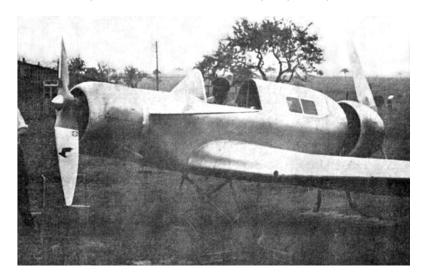
Die Fieseler F 3 "Wespe" zu Beginn der Flugerprobung. Auf der Zweiblatt-Luftschraube läßt sich deutlich das Firmenemblem der Propellerfabrik Gustav Schwarz erkennen. Die Haube des vorderen Cockpits ist noch nicht montiert – vielleicht aus Sicherheitsgründen, um im Erstfall einen schnellen Ausstieg zu ermöglichen. Außerdem läßt sich erahnen, daß die Sicht aus dem hinteren Sitz recht bescheiden gewesen sein muß.
