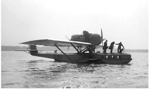
Fluggäste sind mit einem Boot zur D-861 gebracht worden und klettern nun in die Kabine hinunter. Der Einstieg befand sich oben auf dem Bug des Flugboots, war relativ eng und mit einem steilen Niedergang versehen.
