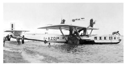
Das Wal-Flugboot I-AZDI (Werknummer 101) wird auf großen, schwimmfähigen Metallrädern ins Wasser gerollt. Die im November 1927 an die italienische Fluggesellschaft S.A. Navigazione Aerea (SANA) gelieferte Maschine trug die Flottennummer "VIII". Wie alle nach 1926 für die SANA gebauten "Wale" war sie mit Piaggio "Jupi-ter"-Sternmotoren ausgerüstet.
